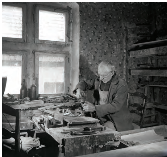
Afb. 6. Het kasten van een pijp door de pijpenmaker Leveque.
