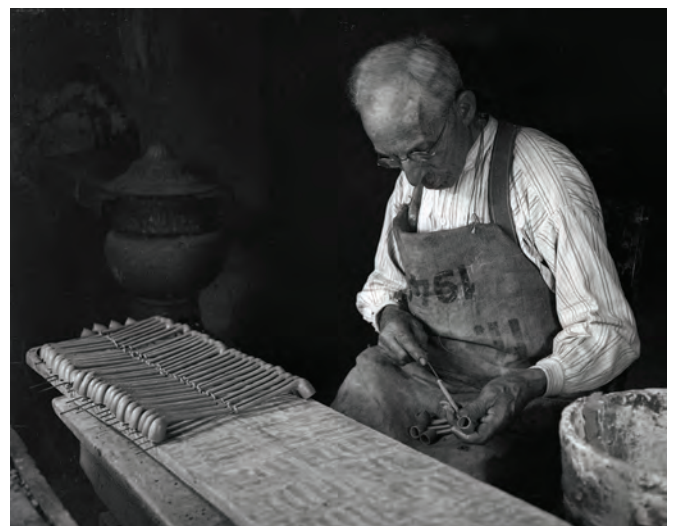
Afb. 7. De pijpenmaker Levêque prikt het rookkanaal door.
